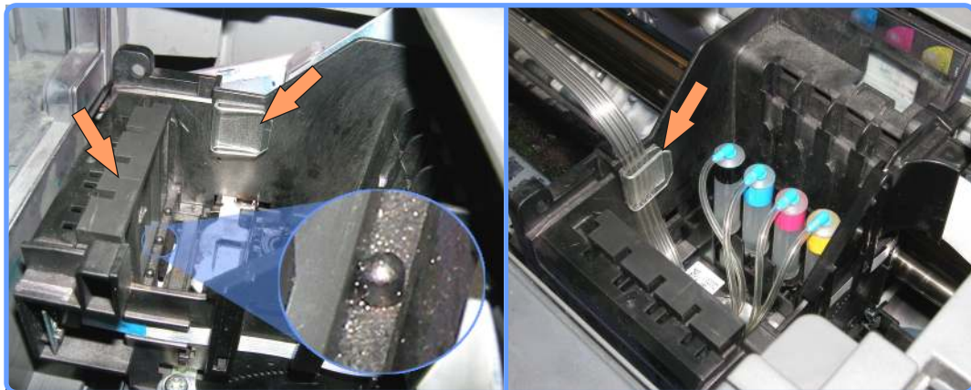
Установка капсул и планки с чипами Сх6400
