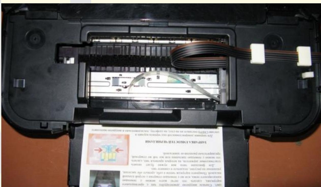
Печатать рекомендуется при открытой верхней крышке. Для более плотного прилегания крышки принтера рекомендуется открутить выступ (штырек) расположенный справа снизу на крышке и отвечающий за определение поднятия крышки.
